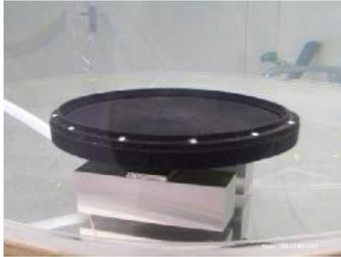
Photo 2 : Distributeur de l'aérateur à fines bulles
