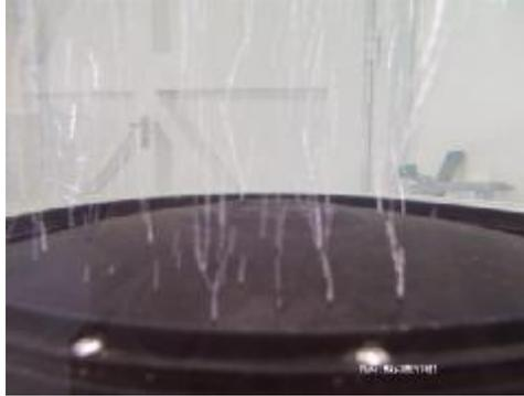
Document 15 : aérateur à fines bulles fonctionnant avec une faible pression de sortie
