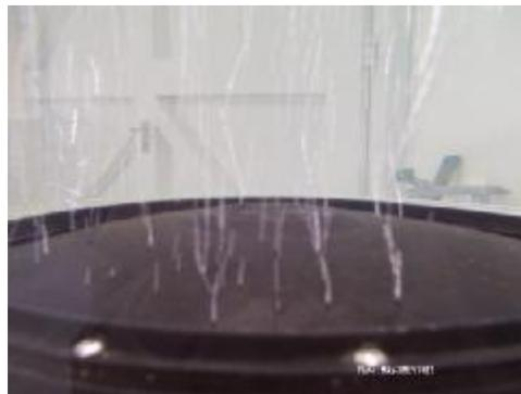
Photo 5 : Distributeur de l'aérateur à fines bulles
